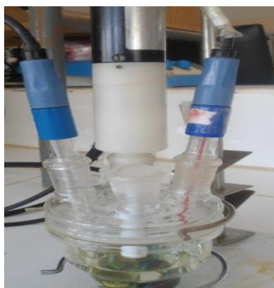
Figure 12: cellule utilisée pour effectuer la voltammétries.
