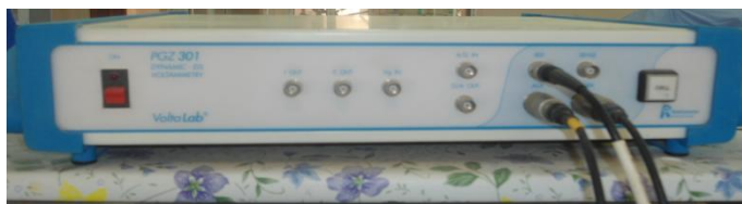
Figure 11: potentiostat-galvanostat utilisé pour la voltammétries.
