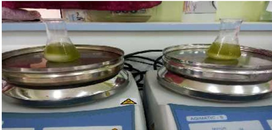
**photo.III.13: Agitation des eaux usées après l'addition de B-COAG.**
