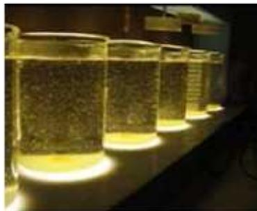
Figure. II.07: Essai de coagulation dans une usine de traitement.
