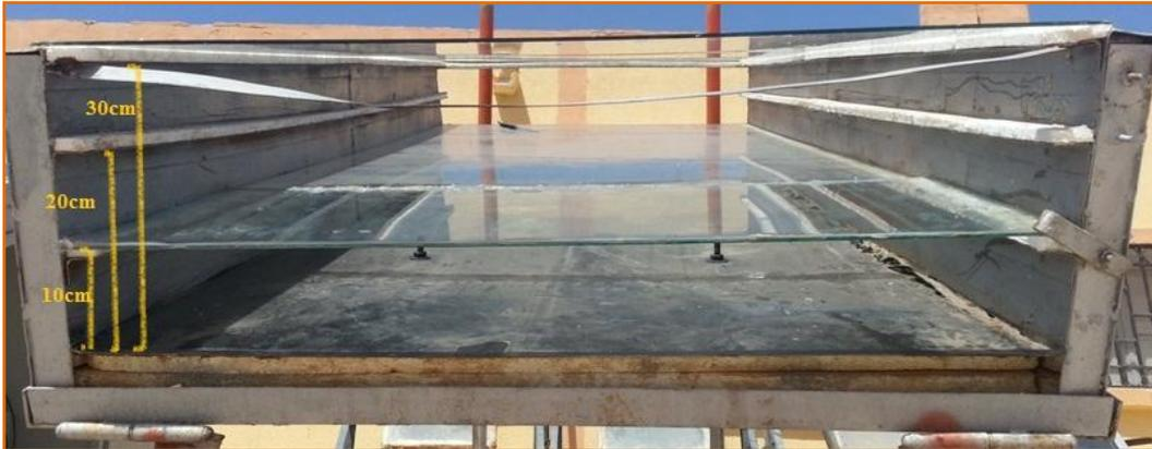
Figure II.6 : Différent épaisseurs d'emplacement de vitre dans la cheminée.
