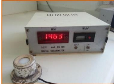
Figure A.1 : solarimètre à affichage numérique.
