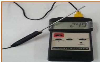
Figure A.2: Thermocouple de type K.
