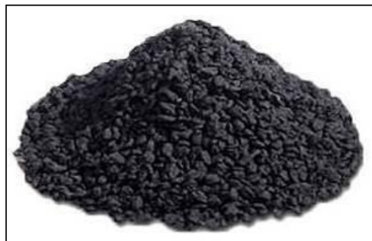
Figure II.3 : charbon actif en grain [17].
