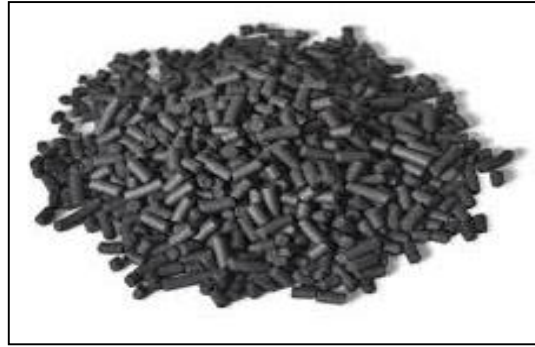
Figure II.1 : charbon actif en extrude [17].
