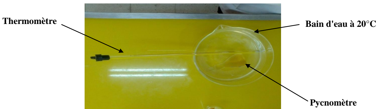
Figure II.5 : Mesure de densité.
