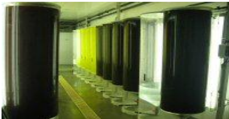
Figure I. 4 : exemple d'un système fermé "photobioréacteurs" de culture d'algue au laboratoire [57].
