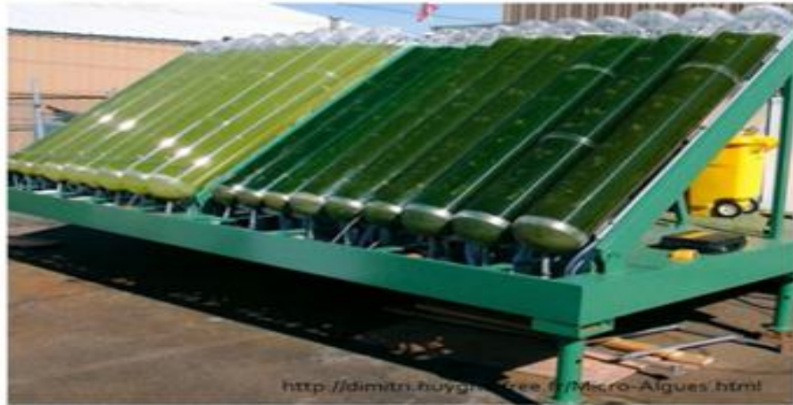
Figure I. 3 : exemple d'un système fermé "photo-bio-réacteurs" de culture d'algue à l'extérieur [56].
