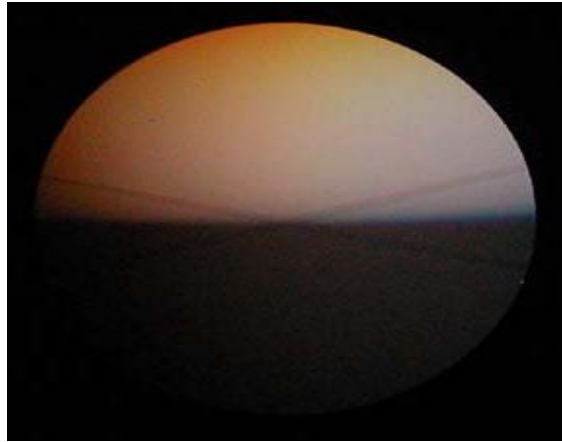
Figure III. 24 : Principe de mesure de l'indice de réfraction Par le refractomètre numérique.
