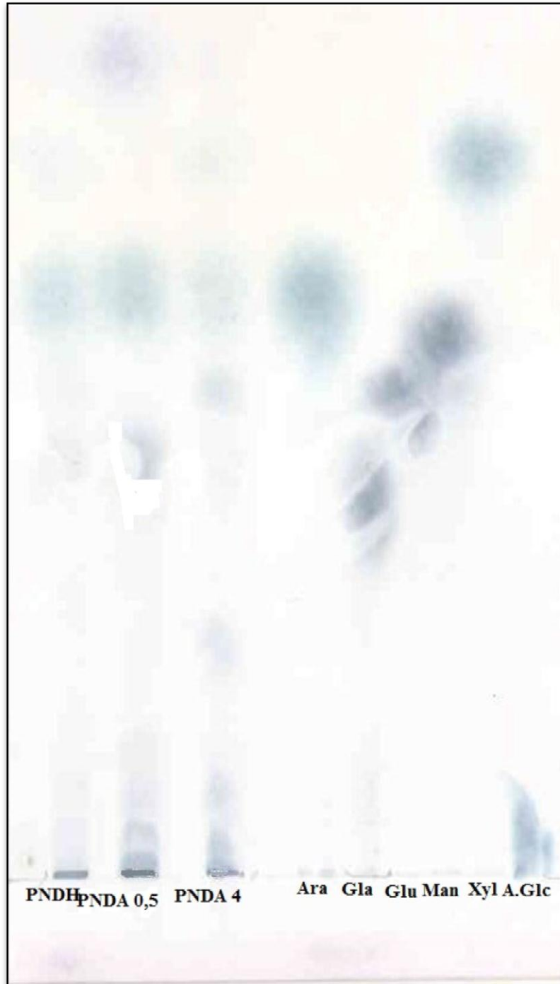
Figure 18.- Chromatogramme des extraits polysaccharidiques des hydrolysats hydrosoluble PNDH et alcalisolubles PNDA 0,5 et PNDA 4 des noyaux de dattes par l'acide trifluoroacétique à 2 M durant 4 heures à 100°C (système 2)
