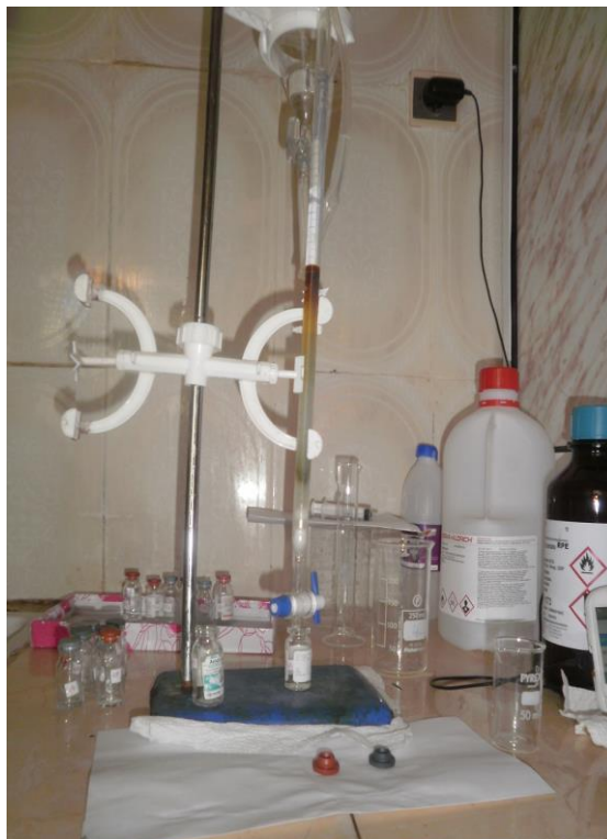
Figure 26 : Colonne de fractionnement des deux extraits
