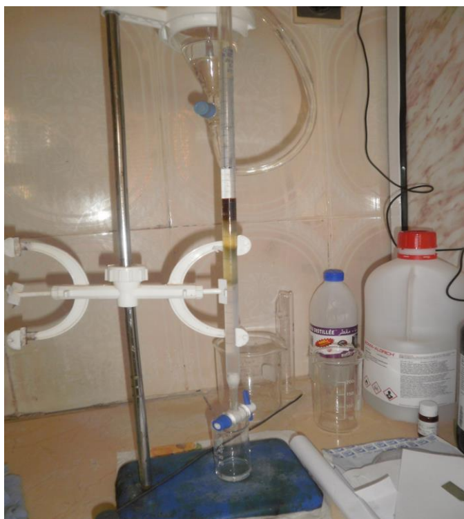
Photo n° 4 : la colonne de fractionnement
