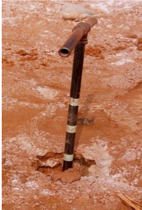
Figure 4.4 . Echantillonnage par la tarière
