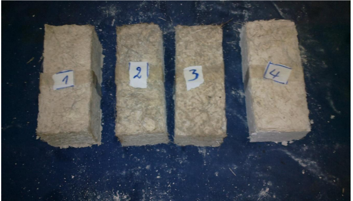
Figure 3.1 : Les différents types de béton de fibre de palmier dattier avec dimensions (L \times I \times H) = (150 \times 70 \times 60) \text{ mm}^3 (échantillons pour l'essai de compression).
