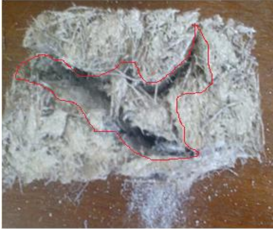
Photo 4 : représente la fissuration d'échantillon après un test de compression
