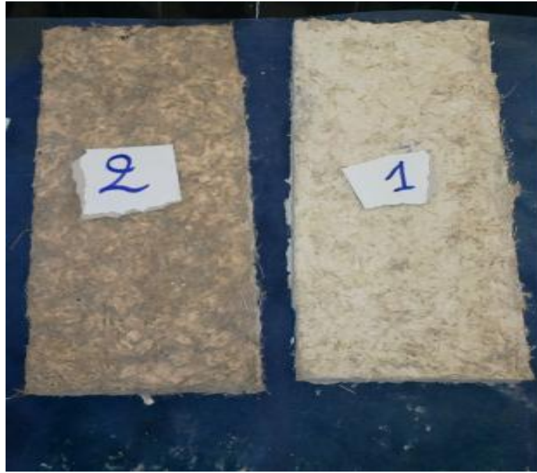
Figure 3.2 : Les échantillons (n° 1, n° 2) pour l'essai de flexion avec dimensions (L \times I \times H) = (360 \times 150 \times 30) \text{ mm}^3 .
