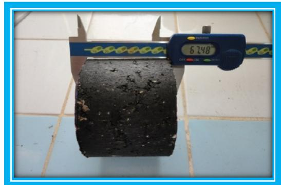
**Photo II.1 Préparation d'une éprouvette pour l'essai Marshall**
