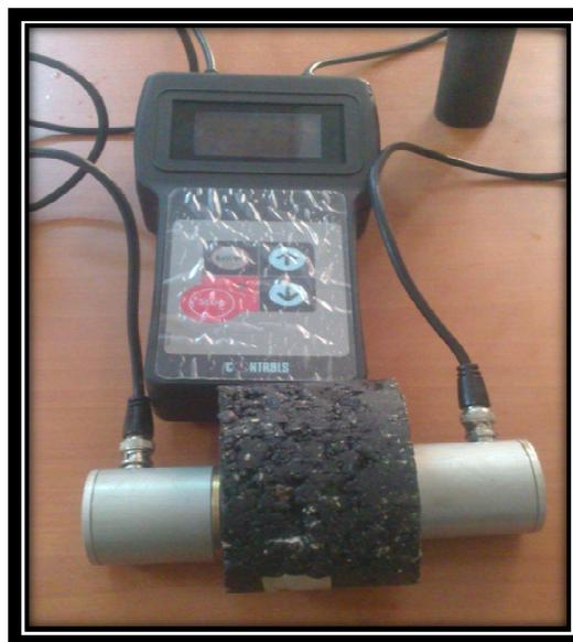
**Photo VI.1** Essai ultrasonique sur éprouvette de béton bitumineux
