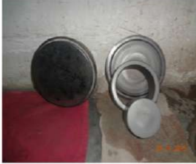
الشكل (20-II): تجهيزات الطحن الخاصة بتقنية ED-XRF
