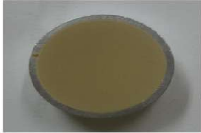
الشكل (21-II): جهاز ضغط العينات و نموذج إحدى العينات في تقنية ED-XRF
