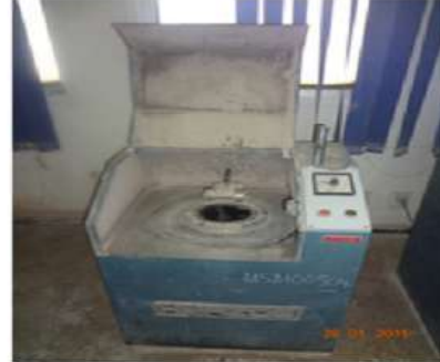
الشكل (20-II): تجهيزات الطحن الخاصة بتقنية ED-XRF
