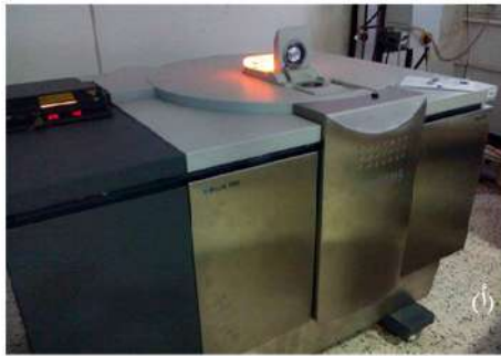
الشكل (II-17): (أ) جهاز DW-XRF المستعمل في الدراسة (ب) المخطط الذي يوضح مبدأ عمله [66]
