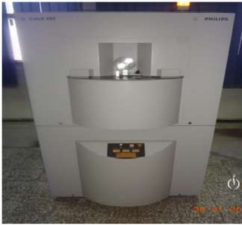
الشكل (II-18): (أ) جهاز ED-XRF المستعمل في الدراسة (ب) المخطط الذي يوضح مبدأ عمله [66]
