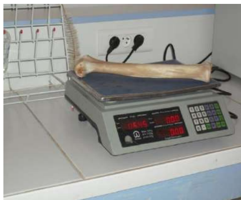
Photo 27 : Balance alimentaire électronique pour réaliser les mesures pondérales des os (précision le g).
