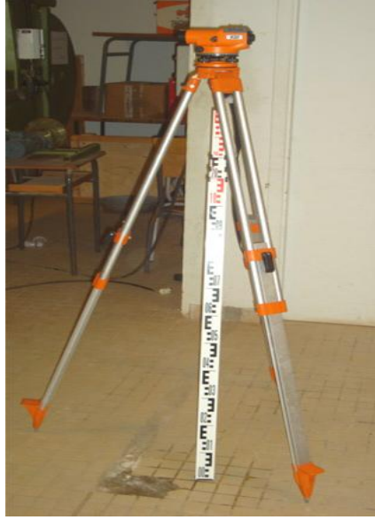
صورة 22 : جهاز التسوية لقياس ميل أرضية قناة التجارب
