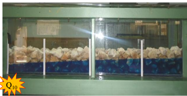
صورة 38 : قياس ارتفاع الماء داخل القناة في حالة الحصى المستعمل D4 ولمختلف التدفقات المستعملة
