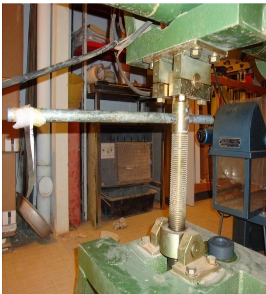
صورة 19 : لولب - صامولة (Vis-écrou) لضبط ميل قناة التجارب
