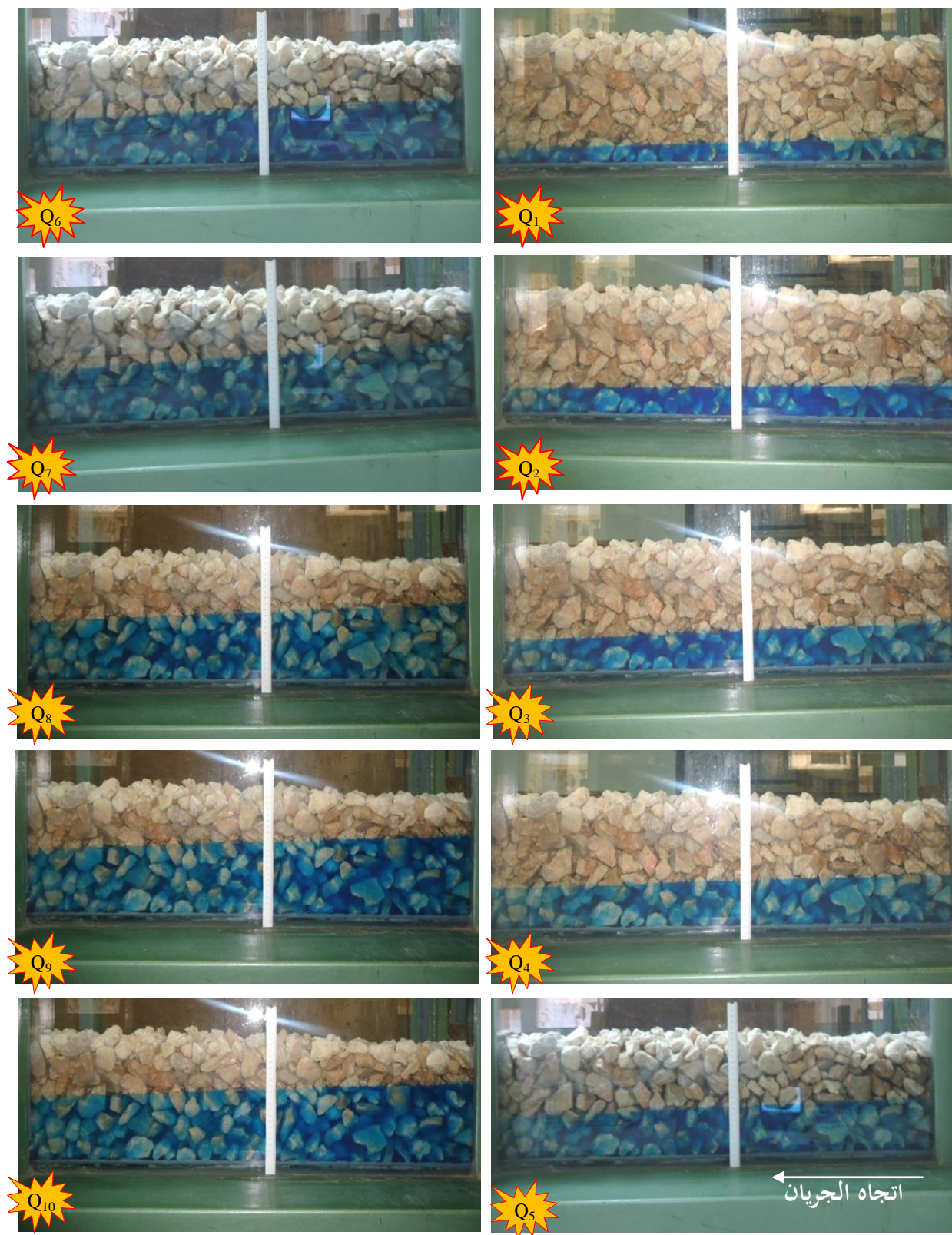
صورة 36 : قياس ارتفاع الماء داخل القناة في حالة الحصى المستعمل D2 ولمختلف التدفقات المستعملة
