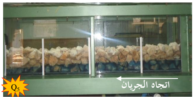
صورة 38 : قياس ارتفاع الماء داخل القناة في حالة الحصى المستعمل D4 ولمختلف التدفقات المستعملة
