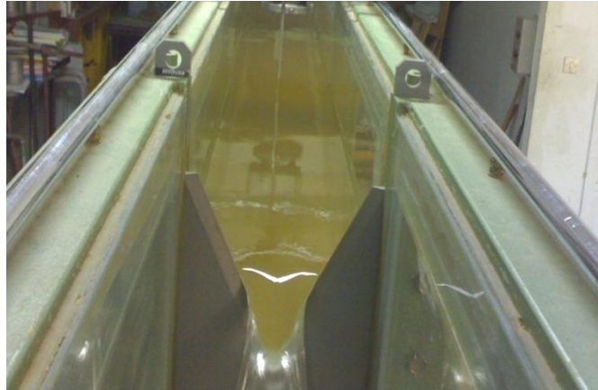
صورة 21 : جهاز الهدّار Déversoir لقياس تدفقات الماء في القناة المفتوحة
