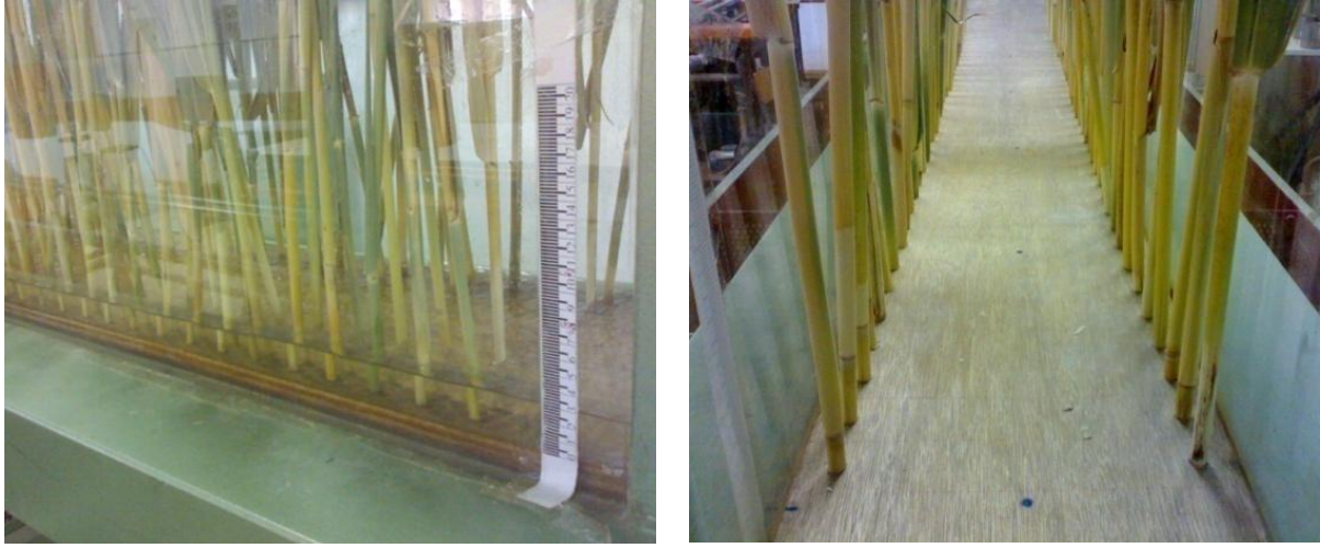
صورة 27 : تجارب بوجود سيقان القصب باستعمال أكبر قطر وبكثافة مختلفة
