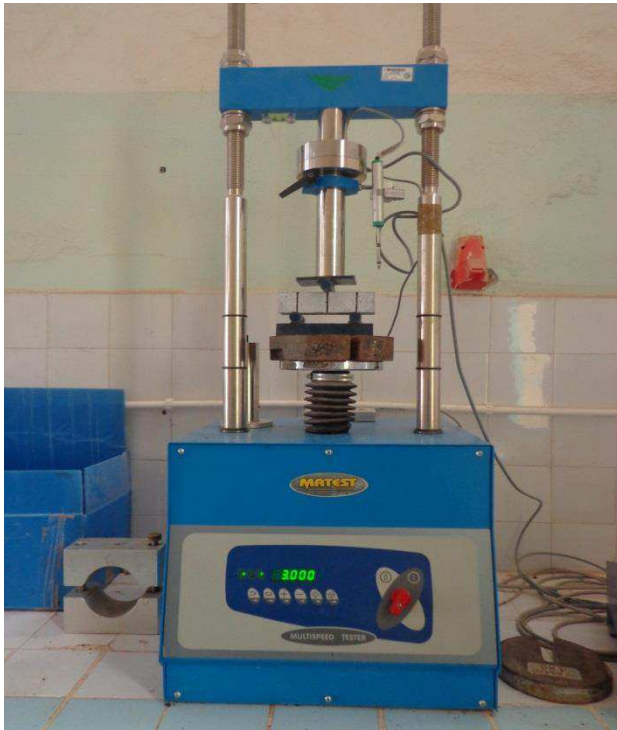
Photo.10. appareil de mesure de traction par flexion
