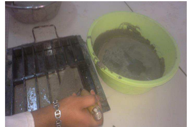
photo.4 Coulage des éprouvettes
