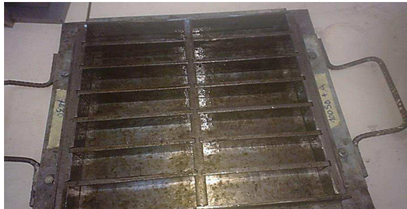
Fig.III.6.Moules (4x4x16) pour moulage des éprouvettes.
