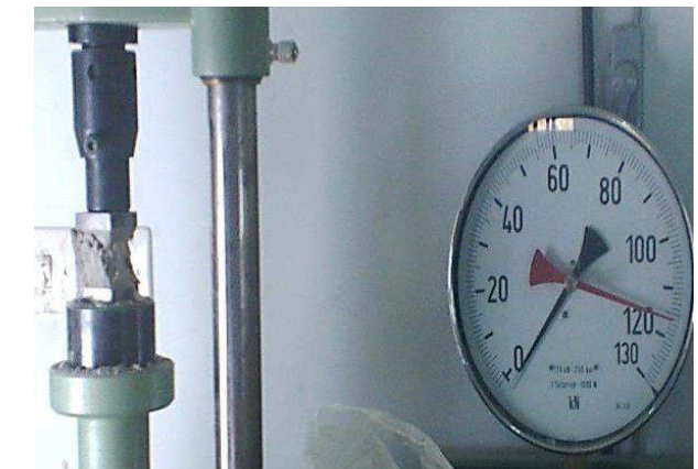
photo.6.écrasement d'une éprouvette en compression
