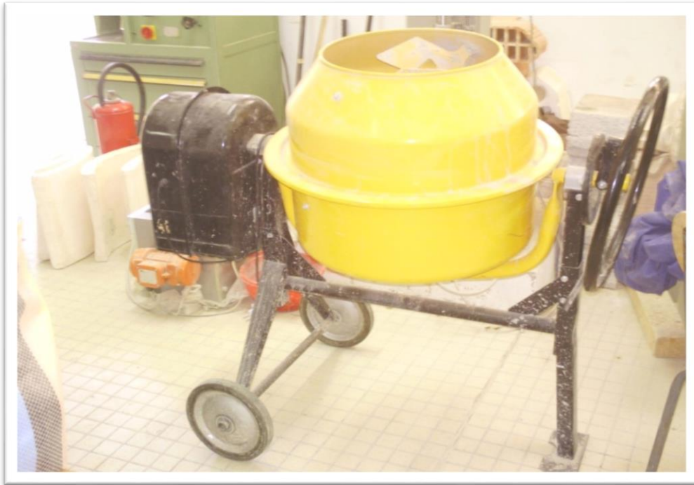
Figure (III.05) : Bétonnière à axe horizontale laboratoire EVRENZA
