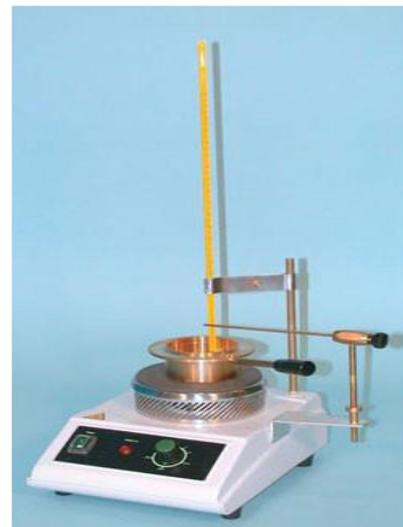
**Figure I.10. Essai de détermination du point d'éclair**
