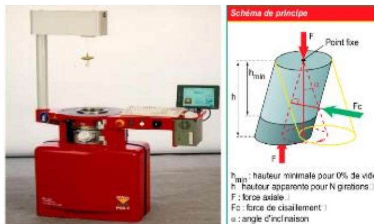
Figure I.23. Presse à cisaillement giratoire (PCG) [60]
