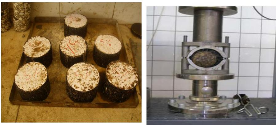
Figure IV.10. Conservation et écrasement des éprouvettes Marshall
