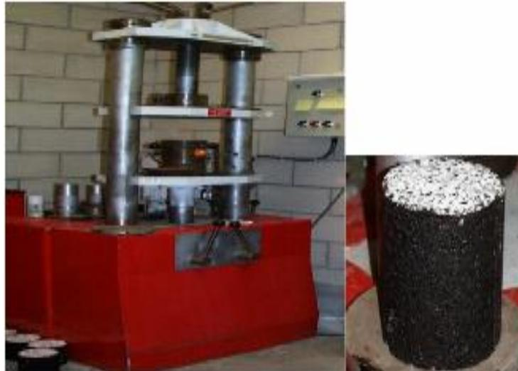
Figure I.22. Schéma de la presse Duriez avec éprouvette [60]
