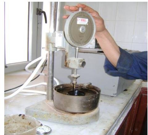
Figure IV.6. Dispositif de l'essai de pénétrabilité à l'aiguille.
