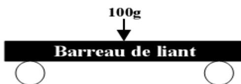
Figure 1.16. Schématisation du principe de l'essai BBR [50]
