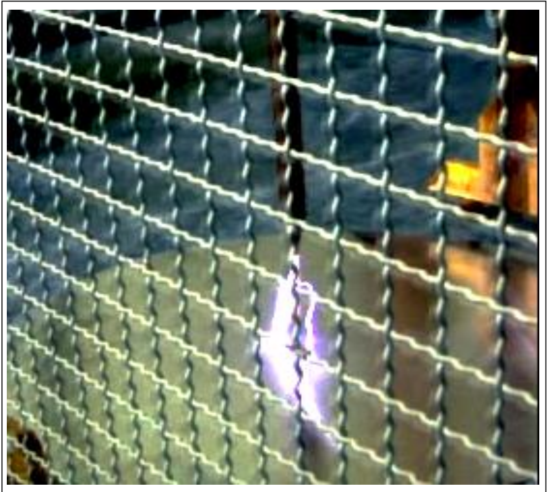
Photo III.3. Décharge directe sans barrière. Essai réalisé au laboratoire haute tension de l'université de Biskra.
