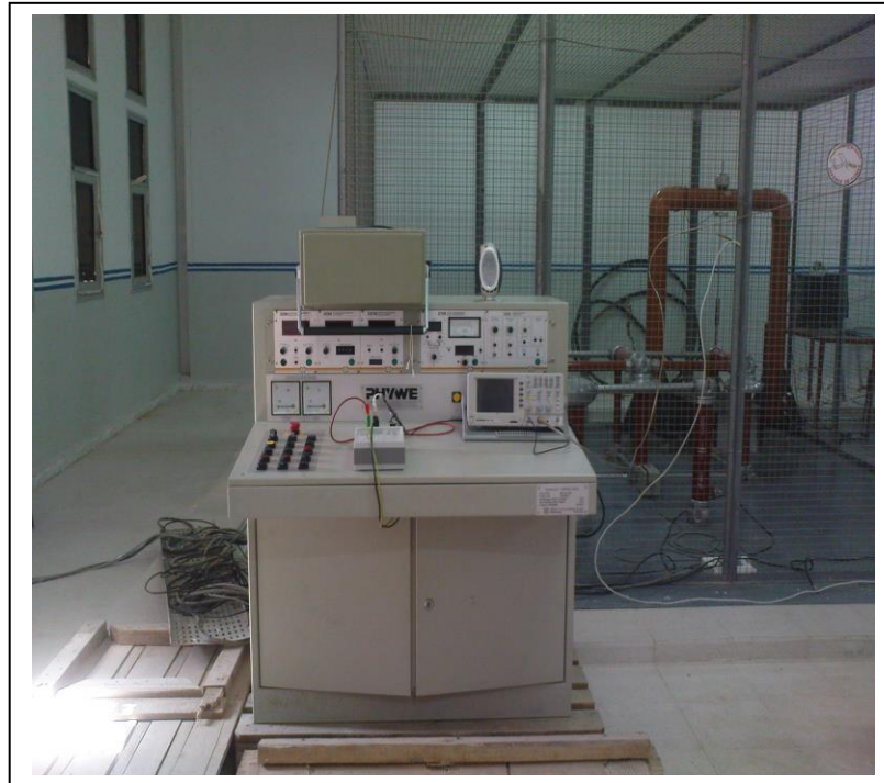
Photo III.1. Photo du pupitre de commande et oscilloscope numérique du laboratoire de haute tension de l'université de Biskra.
