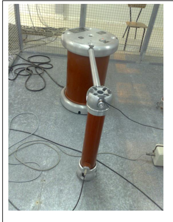
Photo III.2. Photo du circuit d'essai à fréquence industrielle.
