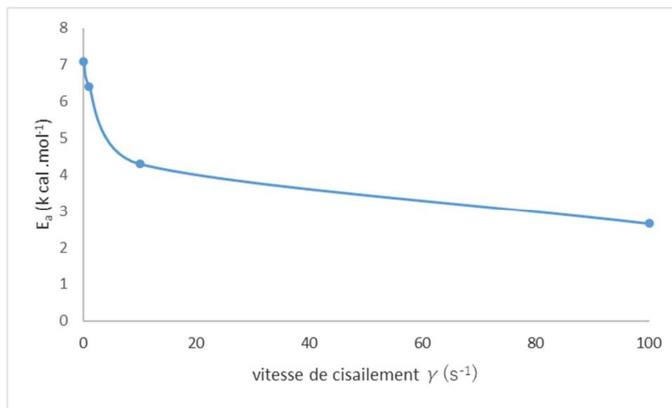
Figure 68: Effet de la vitesse de cisaillement sur l'énergie d'activation de GM 4 %
