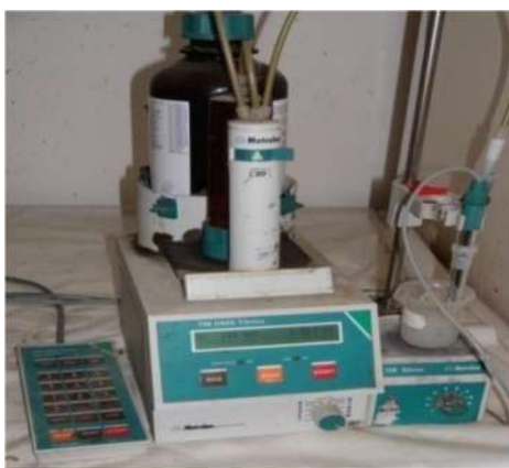
Figure 32 : Potentiomètre Titrino 716 Metrohm.
