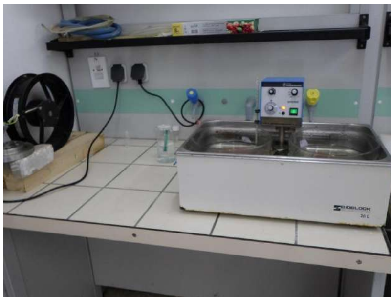
Figure 31 : Dispositif expérimental utilisé pour l'évaporation isotherme de la saumure naturelle du chott Baghdad : Bain thermostaté, cristallisateur, thermomètre et ventilateur.
