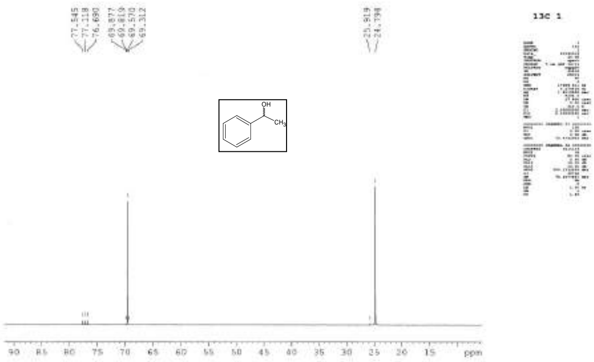
الشكل 7 c : طيف ( ^{13}\text{C} NMR) للمركب فينيل إيثانول (1b) phenylethanol
