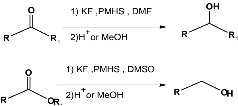
الشكل 17.III: إرجاع المركبات الكربونولية باستخدام PMHS في وجود KF
