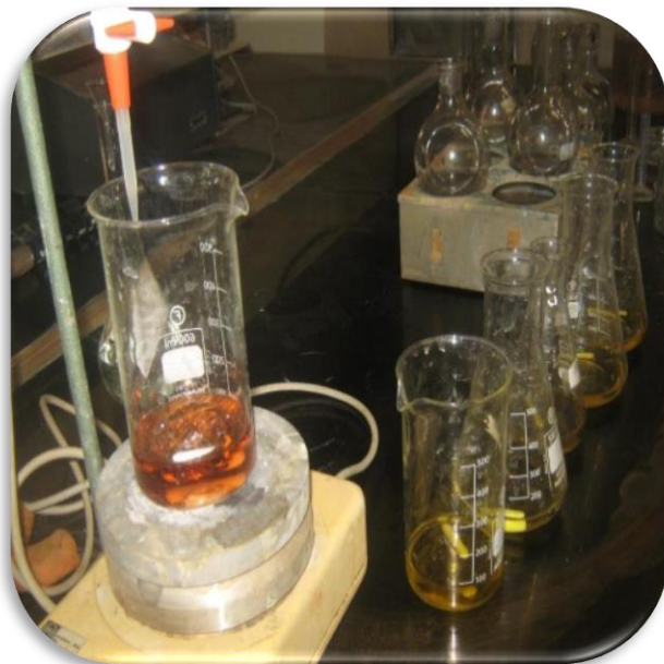
Titration pour déterminer la DCO
