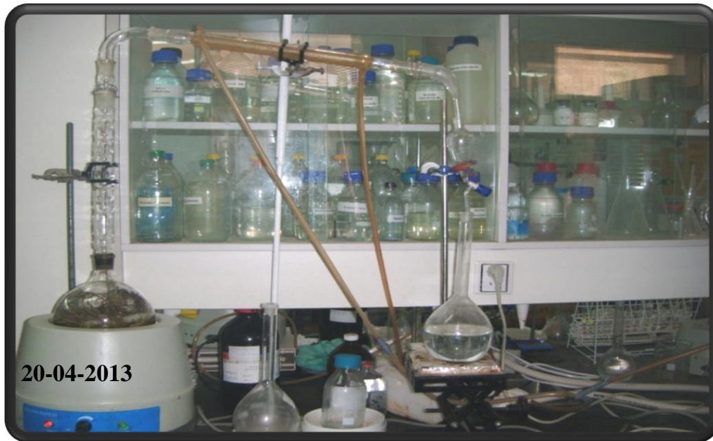
Photo.1: Montage d'hydrodistillation employé pour l'extraction de l'huile essentielle.
