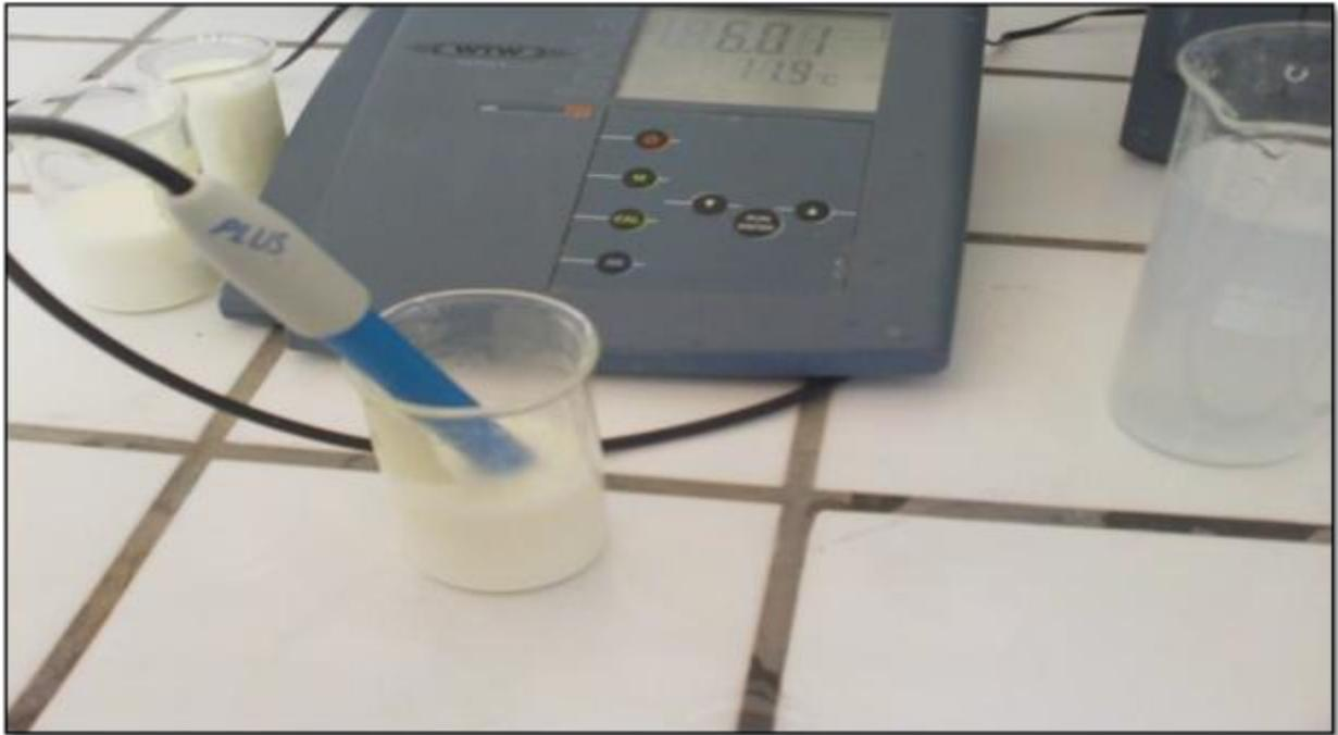
pH mètre, utilisé pour calculer le pH du lait.
