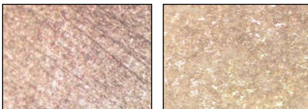
Figure V.2 : Micrographie optique de l'aluminium(5X) à gauche après le polissage, à droite après l'immersion au milieu corrosif.
