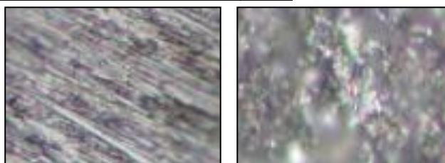
Figure V.4 : Micrographie optique de l'aluminium(20X) à gauche après le polissage, à droite après l'immersion au milieu corrosif.
