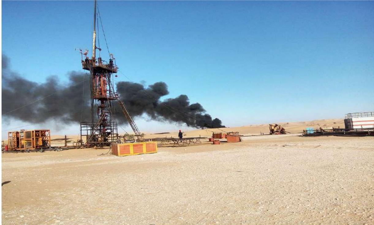
**Figure 3: Opération snubbing sur puit producteur**
