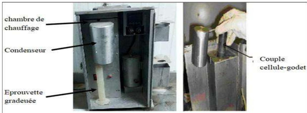
**Figure 21 : Le distillateur à boue**
