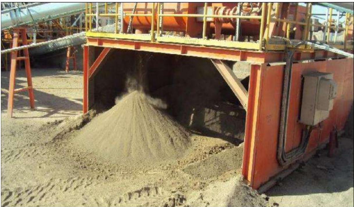
**Figure 20 : rejet après traité par désorption thermique indirect[12]**
