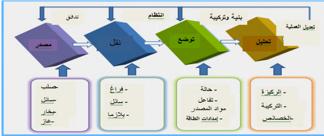
الشكل (1.II): رسم تخطيطي يوضح عمليات ترسيب طبقة رقيقة [7].
