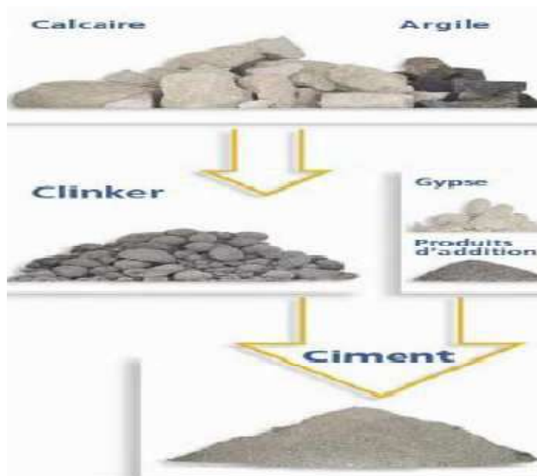
Figure 8 : processus de fabrication du ciment [7].
