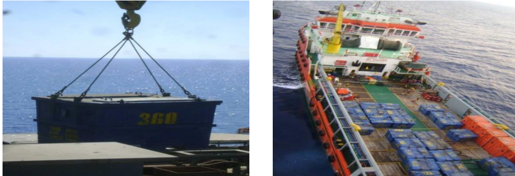
Fig.33. Manutention et transport des déchets de forage (solide et fluide). [32]
