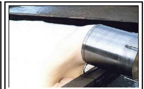
Figure 1.23 : Générateurs moyen foisonnement
