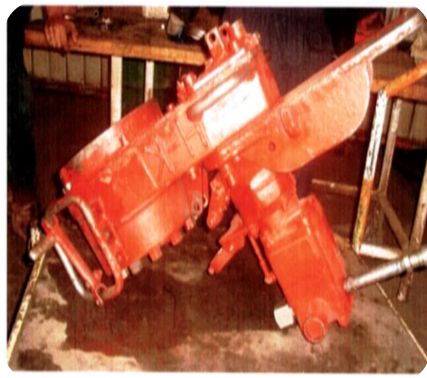
Figure 16 : Clef automatique (POWER TONG)
