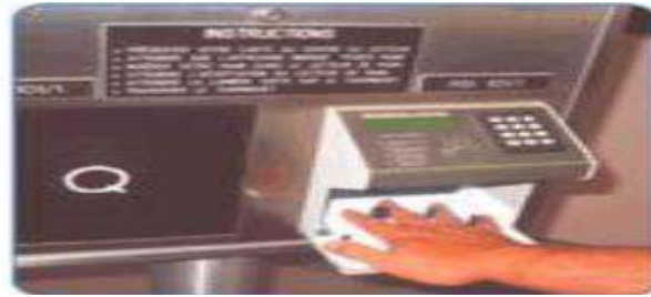
Figure I.7 : Dispositif de reconnaissance par géométrie de la main [6].
