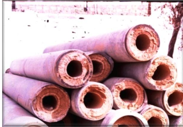
Photos 08 : Les canalisations sont rétrécies par entartrage (DJEDEL M ; 2008)
