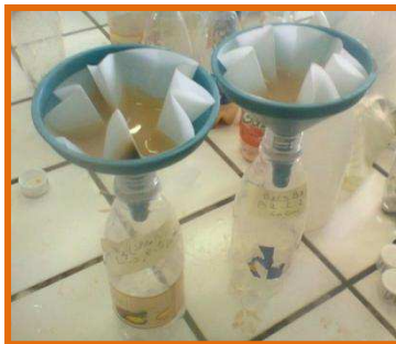
Photo N° 26: filtration de l'extrait du sol
