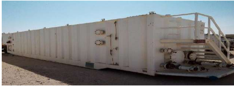
Fig II, 20 : BAC DE STOCKAGE 500 BBL
