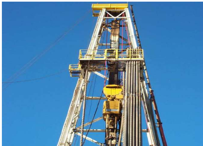
Figure I.1: Le mât de l'appareil de forage
