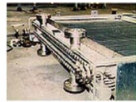
Figure- III-3: manifold type cylindriques sont utilisés pour les pressions de plus de 200 bars
