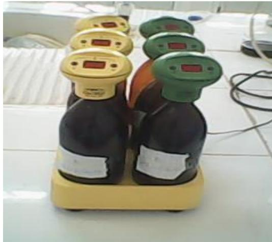
**Figure N°11 : Montage de mesurer de DBO<sub>5</sub>**
