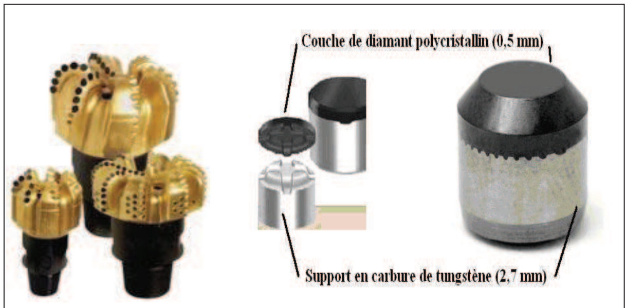
Figure IV-3 : Les outils à diamant (PDC) [7]
