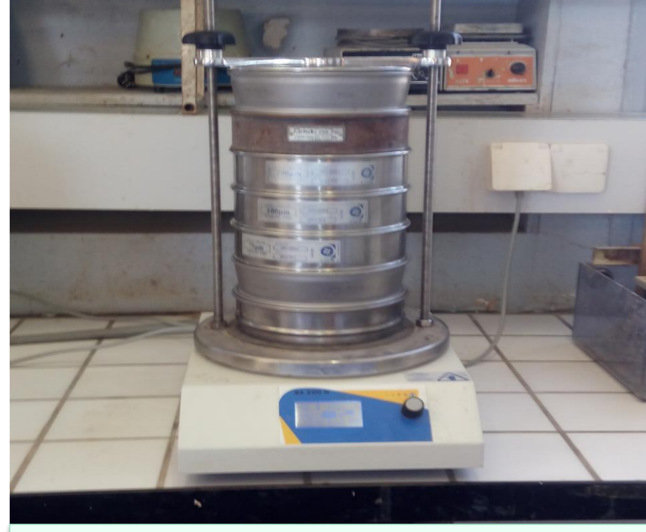
صورة تمثل سلسلة الغربال لقياس التصنيف الحبيبي
