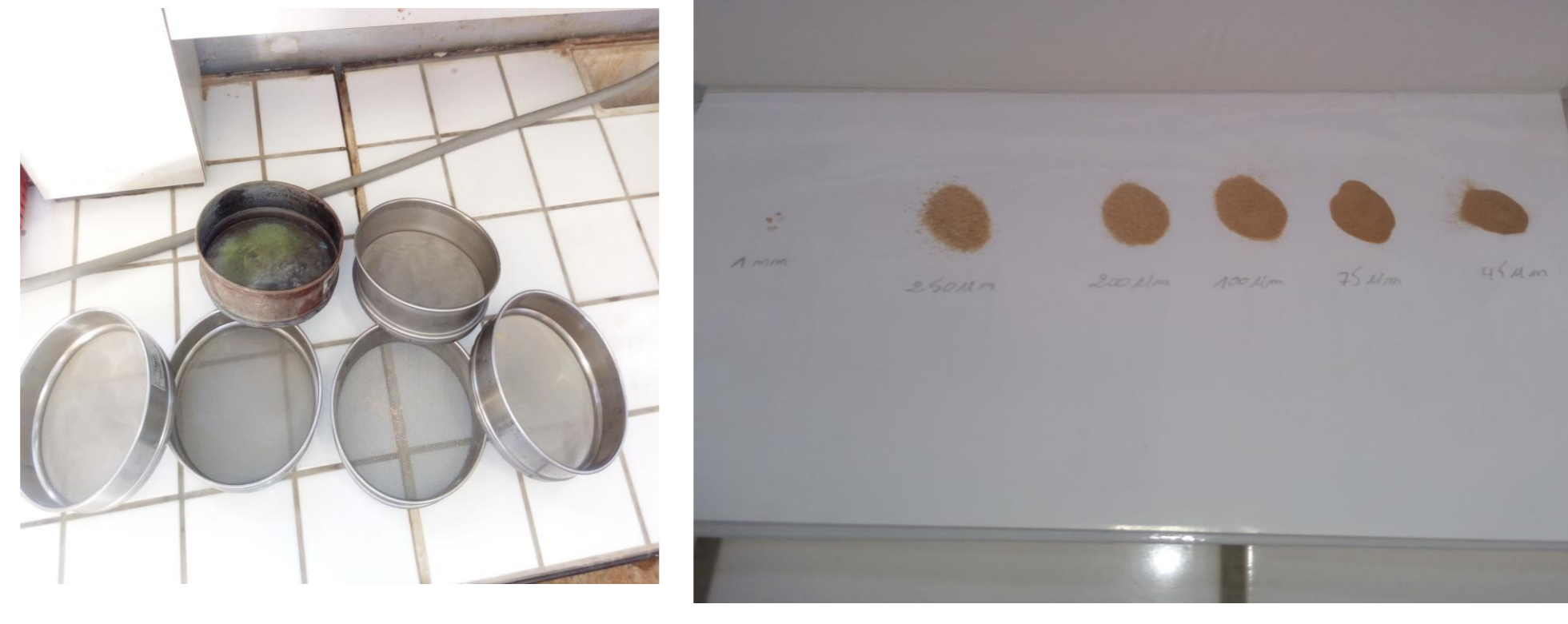
صورة تمثل سلسلة الغربال لقياس التصنيف الحبيبي
