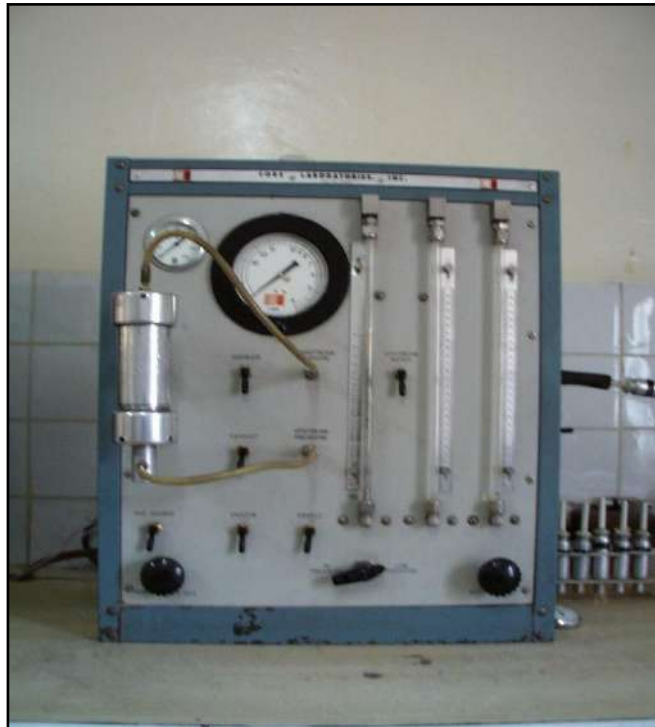
Figure. 08: L'appareil de perméamètre.
