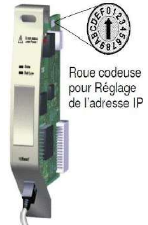
Fig.II.4: Module Ethernet EI 813F –10BaseT.
