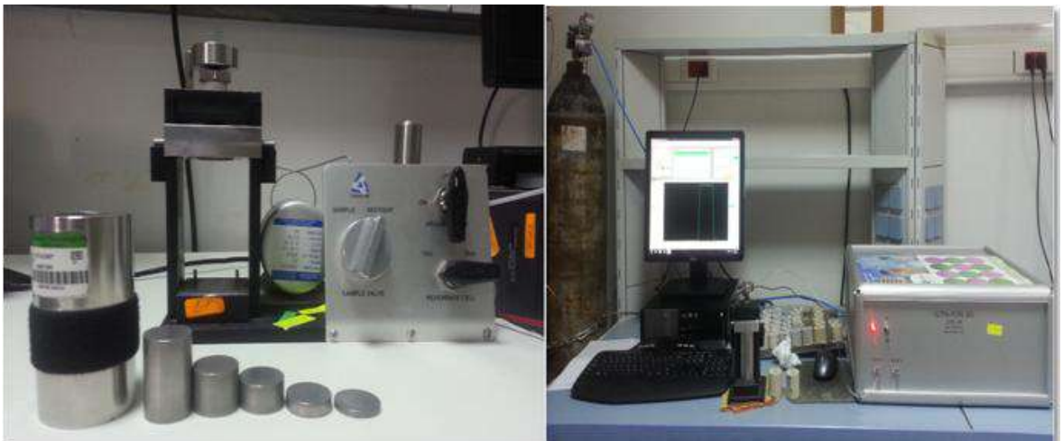
Fig.4.4- Image représentant l'ultra Pore 300 configuré pour le grain volume
