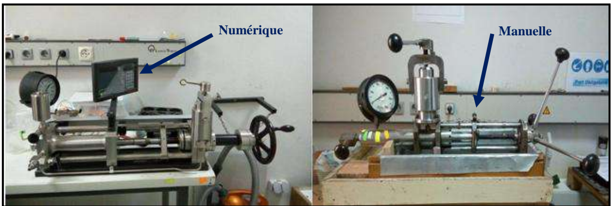
Fig.6.4- Image représentant la pompe volumétrique
