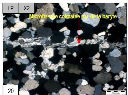
HDZ-10 – 3258.70m : Microfissures colmatées par de la baryte.
