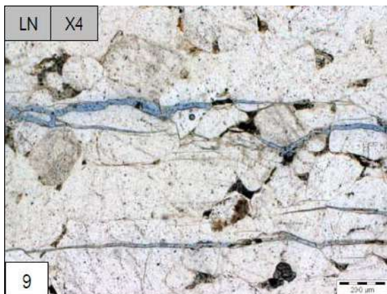
Fig.7.3- HDZ-15 - 3302.84m Effet de la compaction provoquant des microfissures ouvertes.
