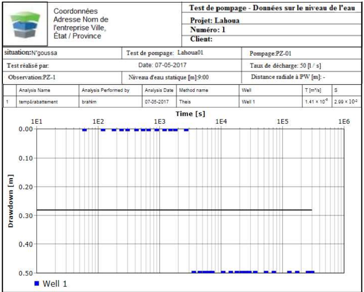
Figure.40 : Essai de pompage longue durée à Lahoua1 interprété Par la méthode de Theis
