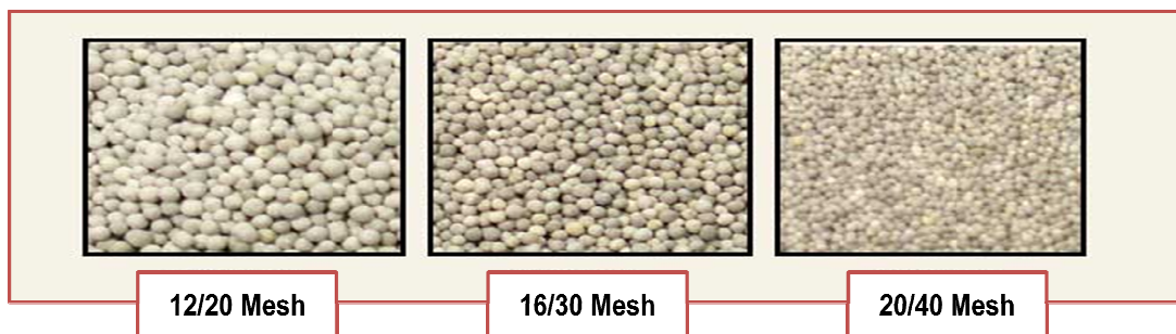
Fig II.5 : différents types de proppants
