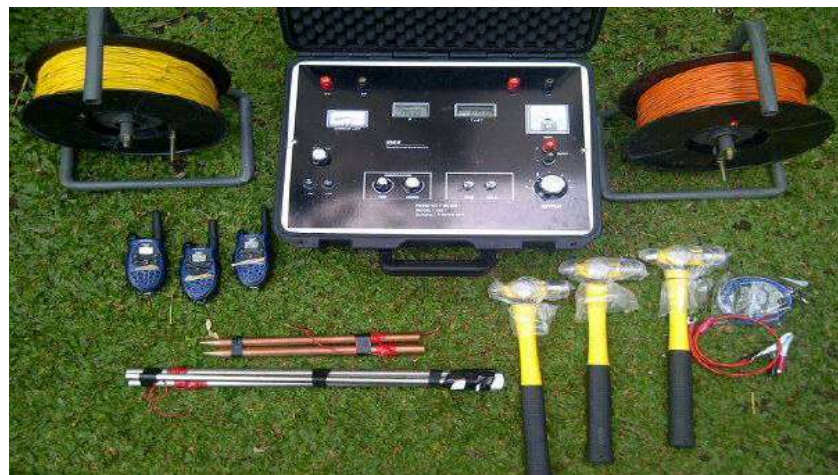
Figure 28: Les matériels de sondages électriques.
