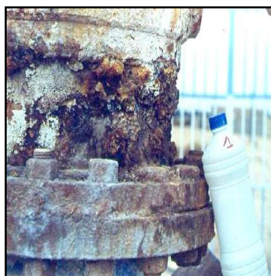
Figures. N°38 : Photos illustrant le caractère agressif des canalisations de la vallée d'oued Righ.
