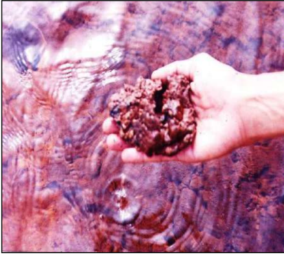
Figure. N°41 : Dépôt de tartre sur les murs du refroidisseur.
