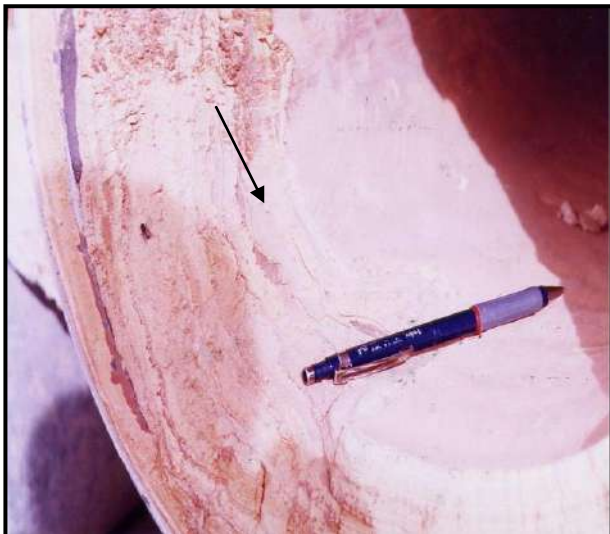
Figure. N°37: Photos illustrant les dépôts de tartre sur les canalisations.
