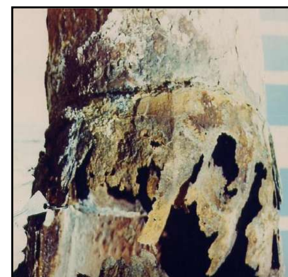
Figures. N°38 : Photos illustrant le caractère agressif des canalisations de la vallée d'oued Righ.
