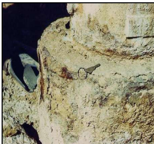
Figures. N°38 : Photos illustrant le caractère agressif des canalisations de la vallée d'oued Righ.
