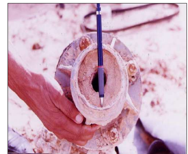
Figure. N°37: Photos illustrant les dépôts de tartre sur les canalisations.
