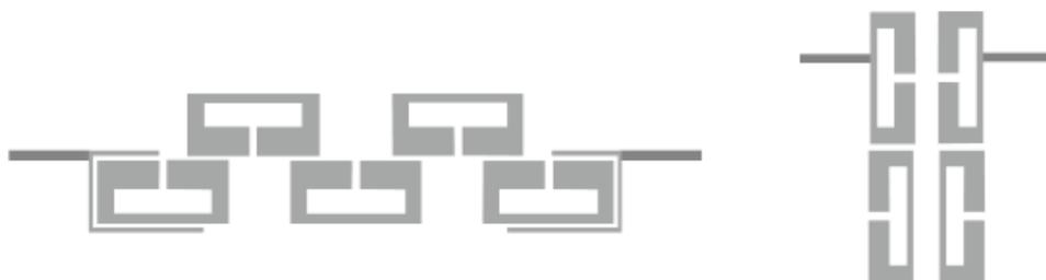
**Figure 1.12** présentation de filtres à résonateurs à saut d'impédance couplés [9]
