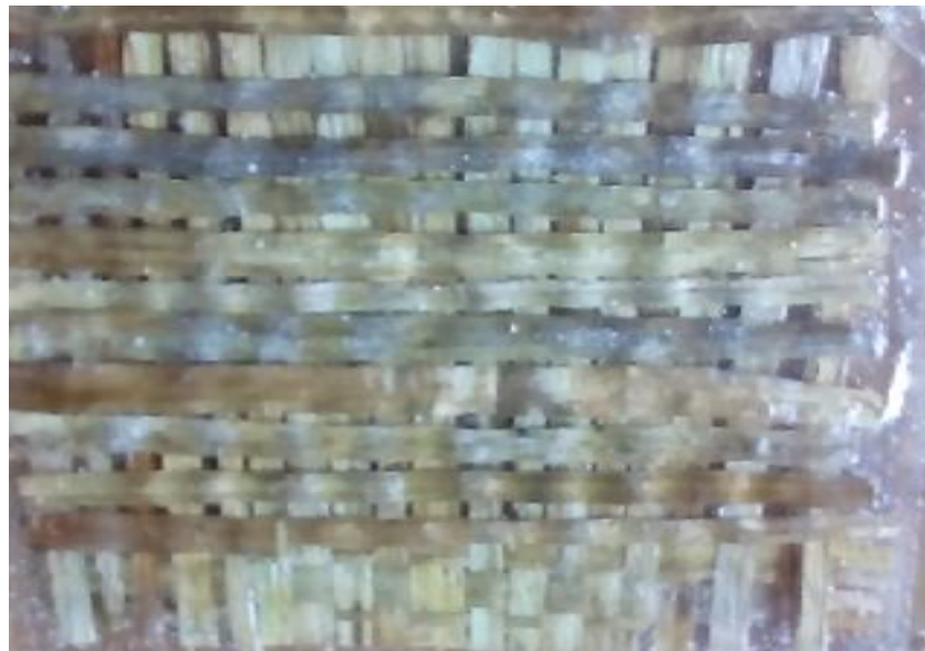
Plaque en composite à renfort de liber de Daphne Gnidium
