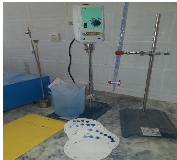
Figure III-10 : essai de Bleu méthylène
