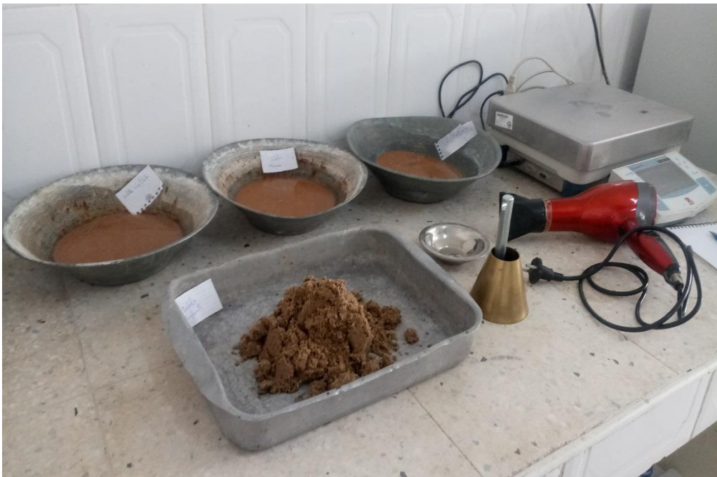
Figure III-8 : essai de capacité d'absorption d'eau.
