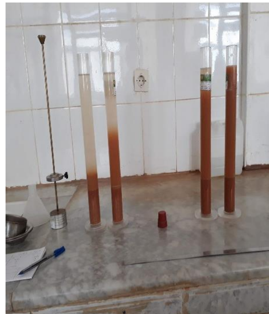
Figure III-7: essai de l'équivalent de sable.
