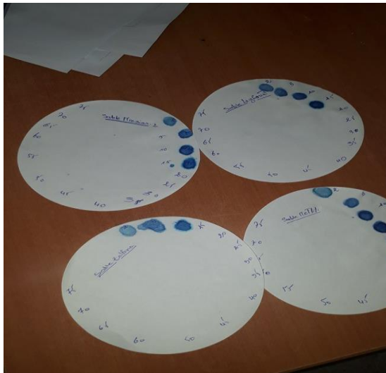
Figure III-9 : les taches de bleu de notre sable
