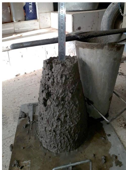
Figure IV-1 : Affaissement du béton
