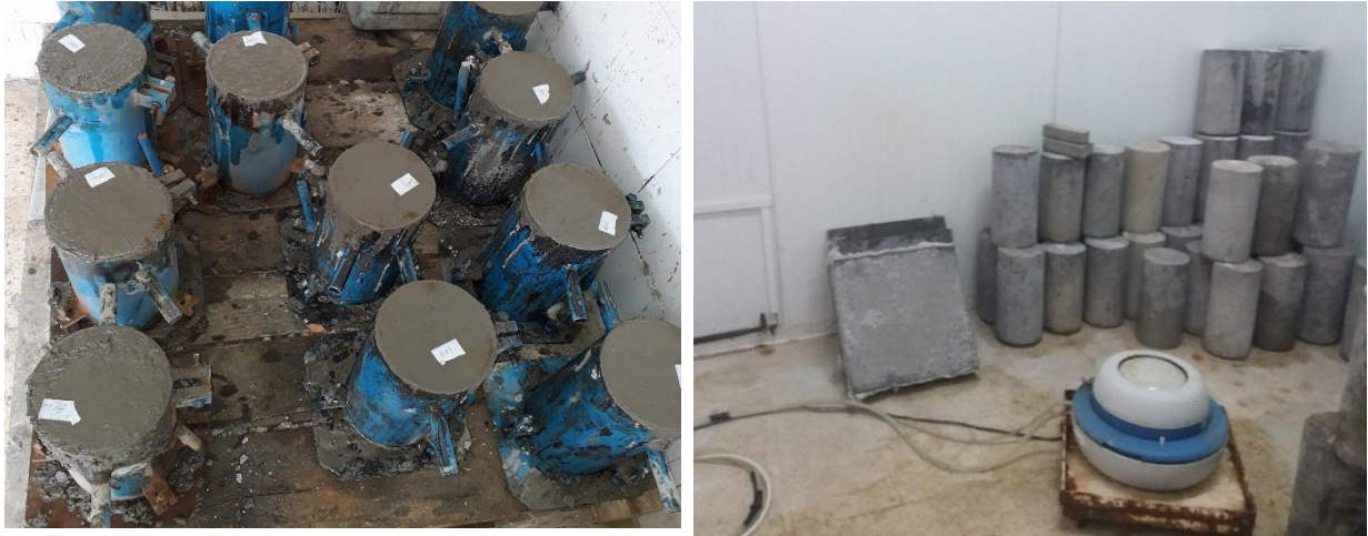
Figure III-15 : confection et conservation d'éprouvette.
